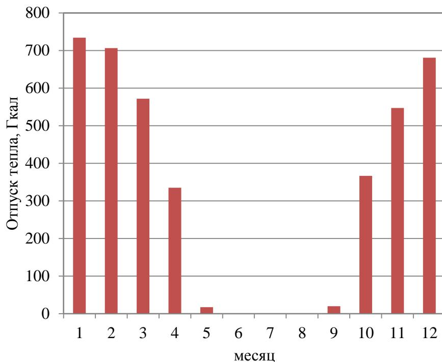
Рисунок 1.3 – Оптимальный температурный график отпуска тепловой энергии для БМК с. Красносельское
