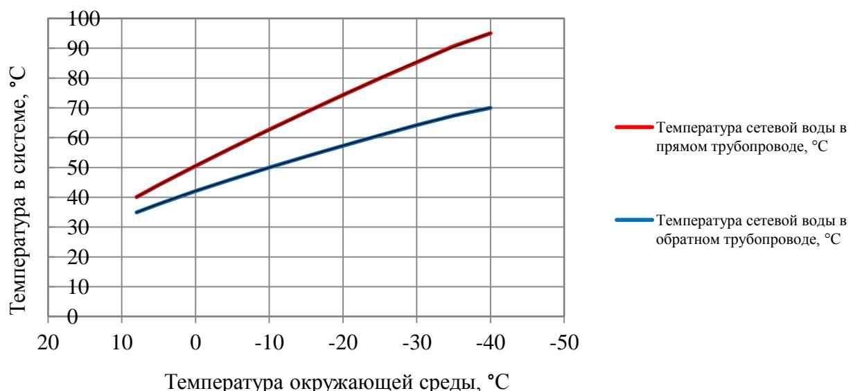
Рисунок 2.3 – График изменения температур теплоносителя 95–70 °C
