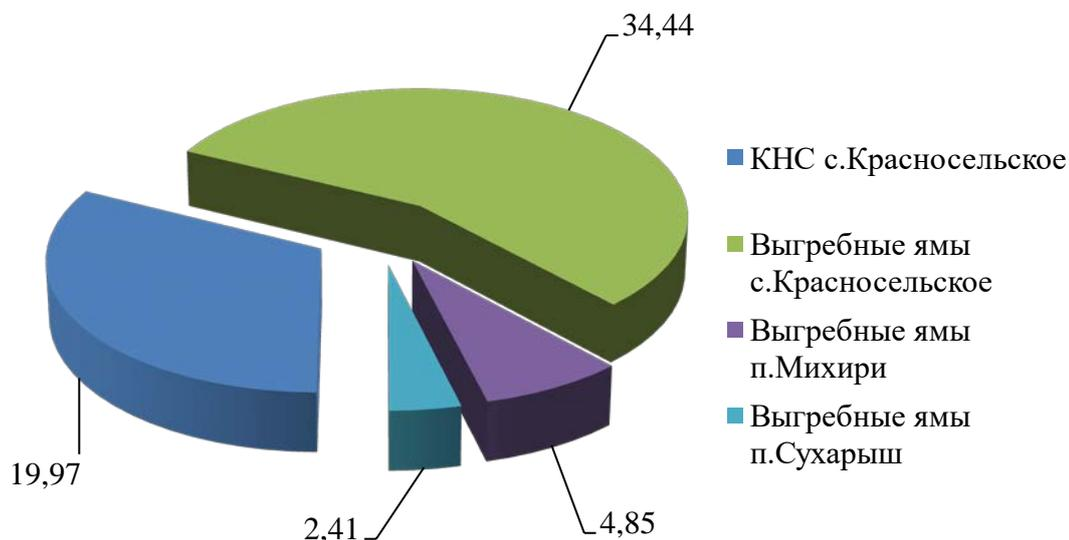
Рис. 22.– Баланс поступления сточных вод в централизованную и нецентрализованную систему водоотведения Красносельского сельского поселения и отведения стоков
