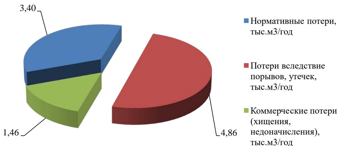
Рис. 5. – Структурные составляющих потерь холодной воды при ее производстве и транспортировке
