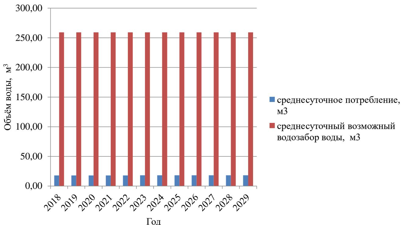
Рис. 20.– Соотношение существующей и максимальной мощности водозаборных сооружений централизованной системы водоснабжения п. Михири
