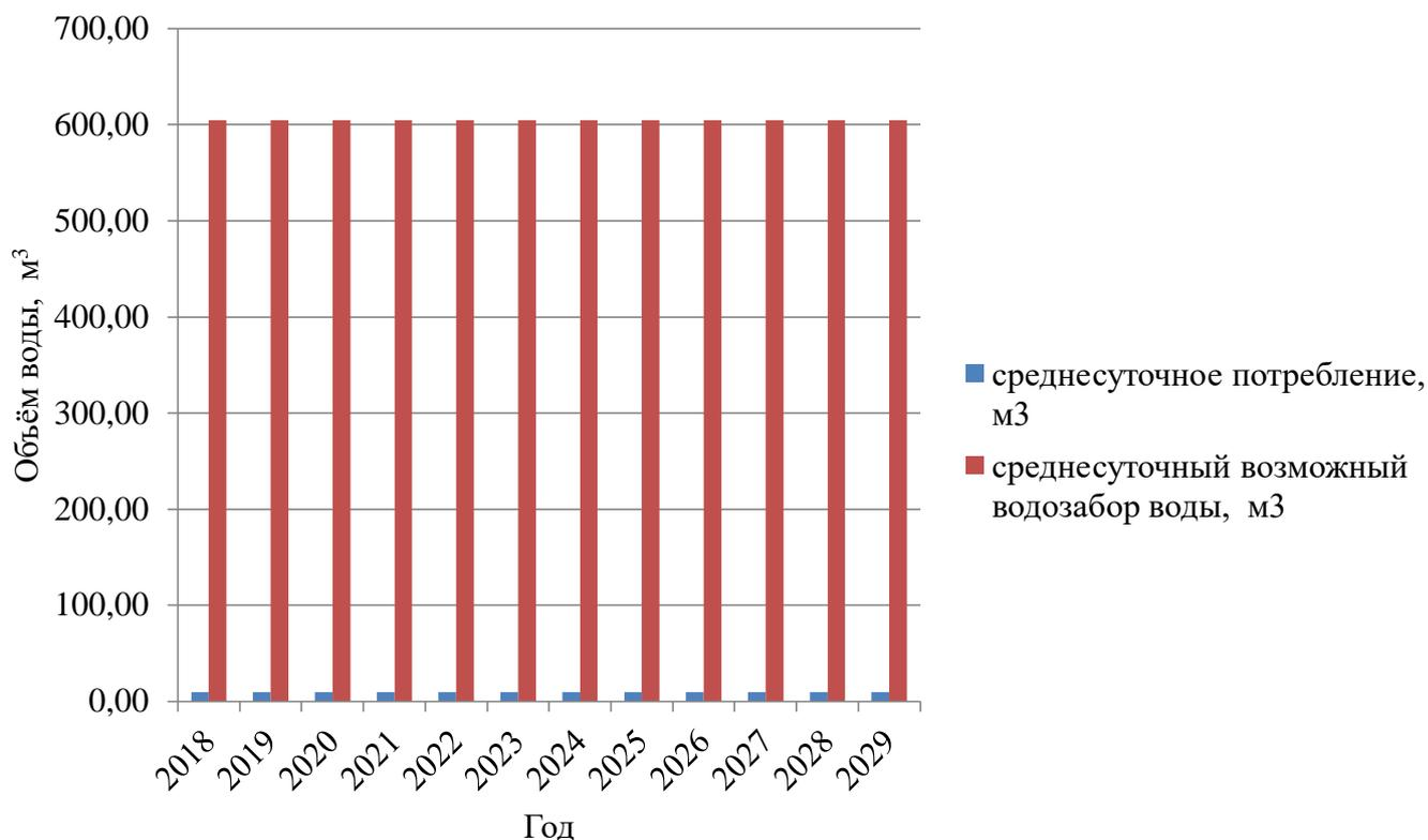
Рис. 21.– Соотношение существующей и максимальной мощности водозаборных сооружений централизованной системы водоснабжения п. Сухарыш
