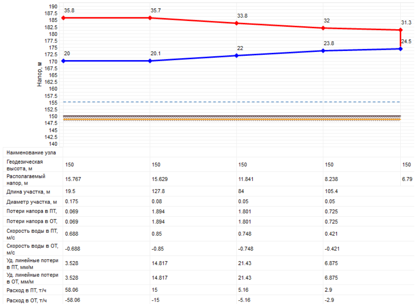
Рисунок 2.67 – Пьезометрический график от источника теплоснабжения котельной Восточная до самого удаленного потребителя
