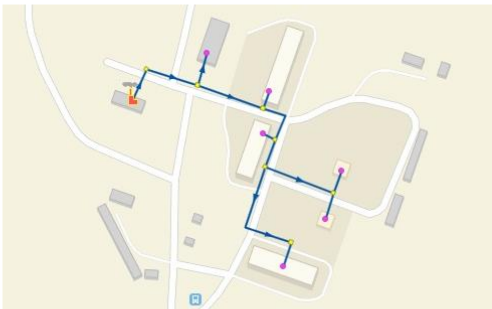
Рисунок 2.34 – Модель системы теплоснабжения котельной Бархотка
