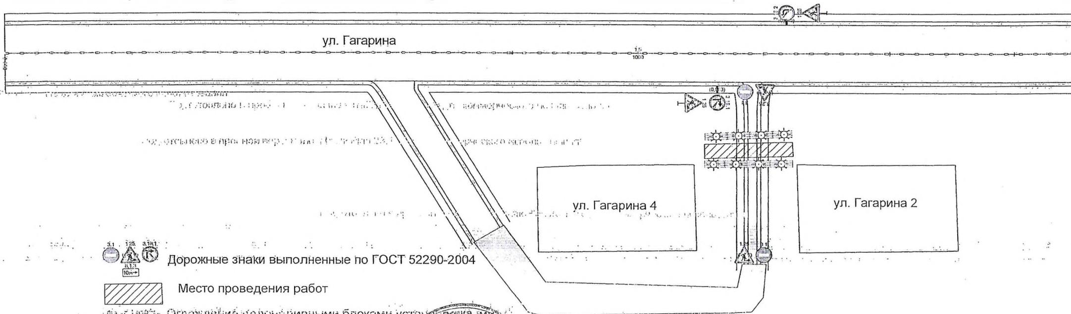
Ограждение водоналивными блоками установленными без разрыва с освещением в темное время суток
