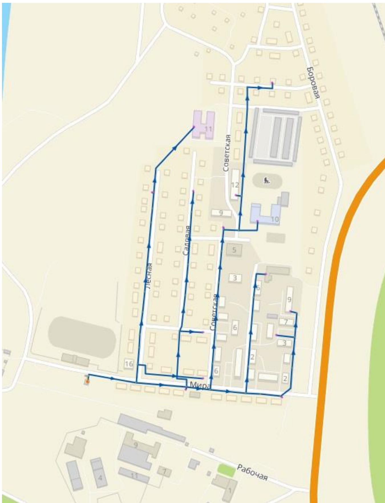
Рисунок 2.31 – Модель системы теплоснабжения Котельной п. Нагорный
