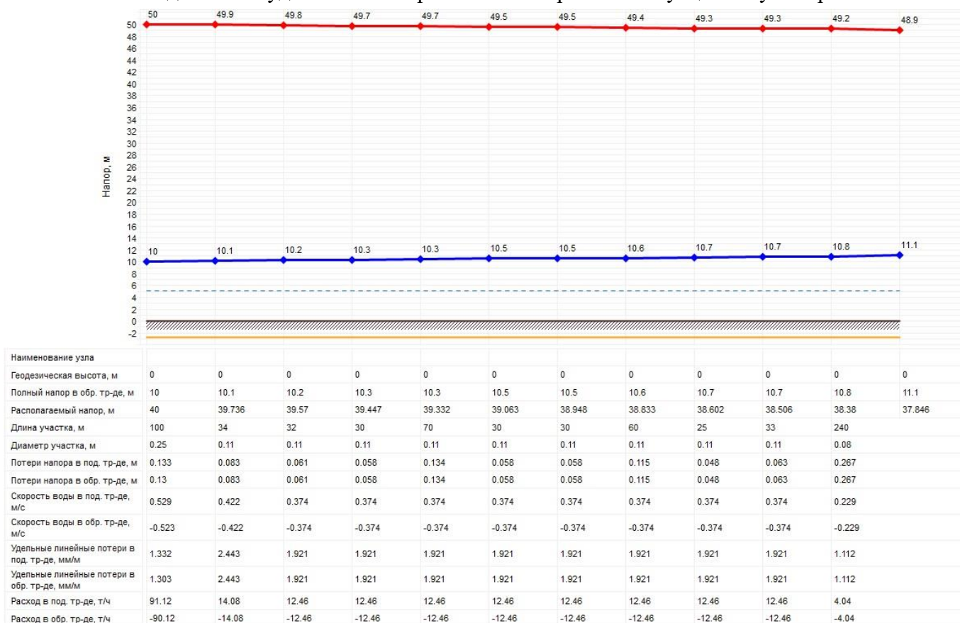
Рисунок 2.42 Пьезометрический график от Котельной п. Нагорный до самого удаленного потребителя в аварийной ситуации здания детского сада
