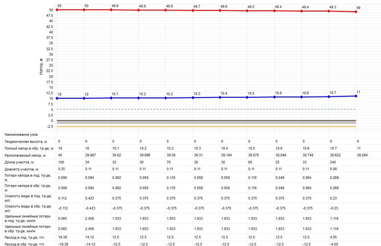
Рисунок 2.35 – Пьезометрический график от источника теплоснабжения (Котельной п. Нагорный) до самого удаленного потребителя – детского сада
