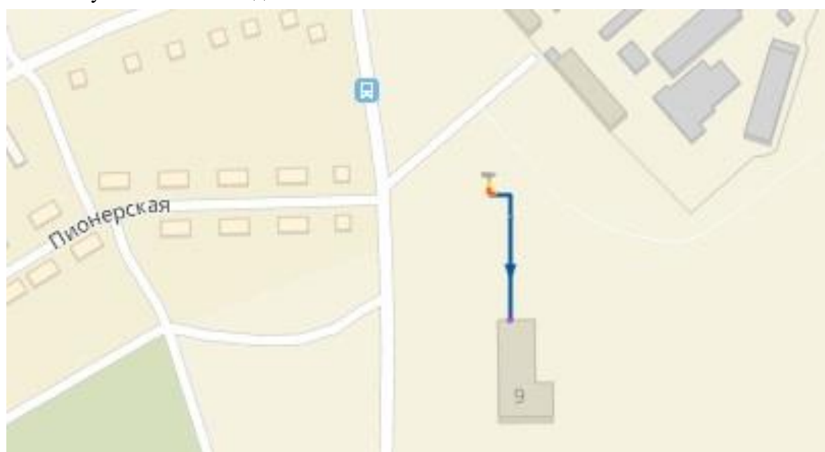
Рисунок 2.30 – Модель системы теплоснабжения Котельной ТКУ-1000 с. Кичигино
