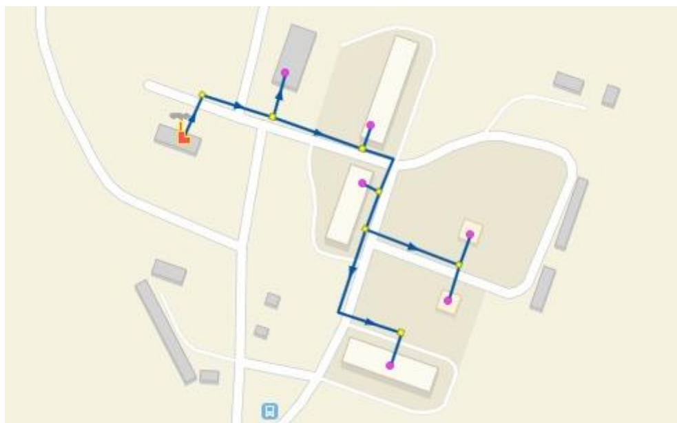
Рисунок 2.34 – Модель системы теплоснабжения котельной Бархотка
