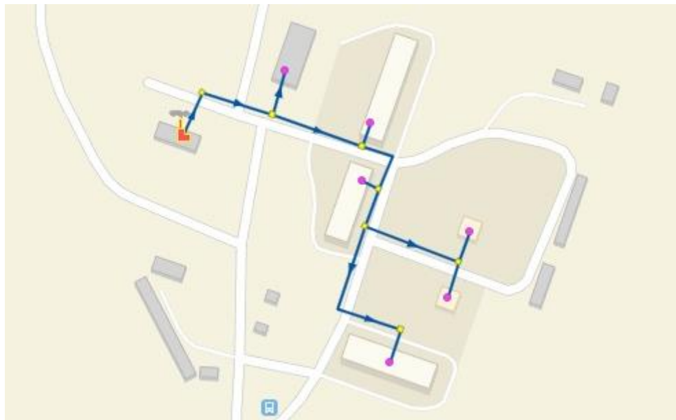
Рисунок 2.60 – Модель системы теплоснабжения котельной Бархотка
