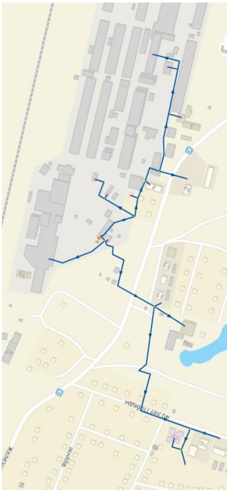
Рисунок 2.64 Модель системы теплоснабжения котельной Злак
