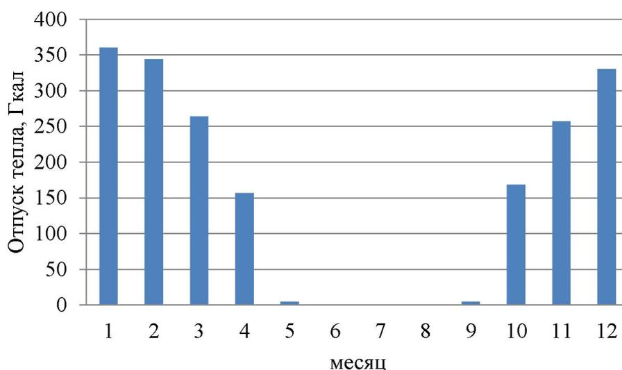
Рисунок 1.6 Оптимальный температурный график отпуса тепловой энергии для БМК п. Березовка с температурным режимом 95-70 °С
