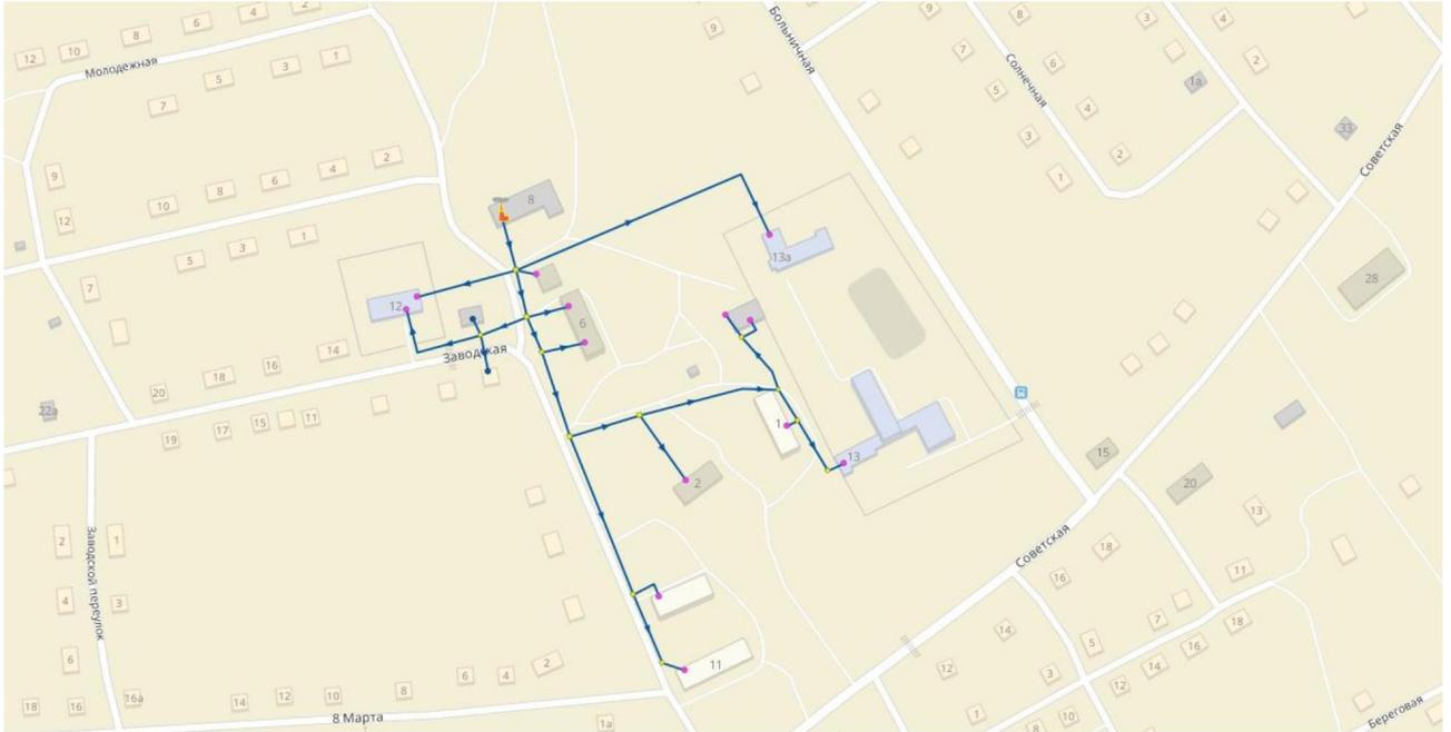
Рисунок 2.14 – Модель системы теплоснабжения Котельной п. Каменский
