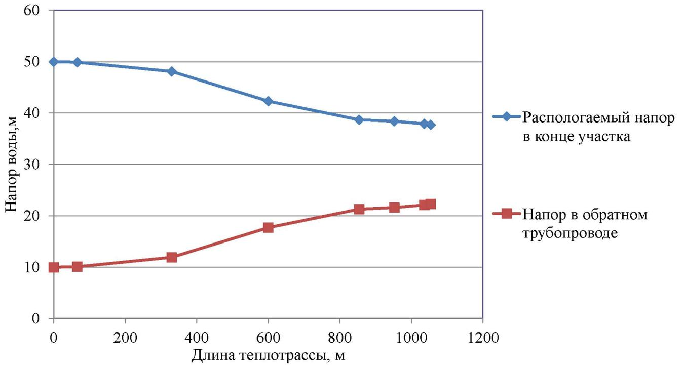
Рисунок 2.9 – Пьезометрический график тепловой сети Котельной п. Каменский
