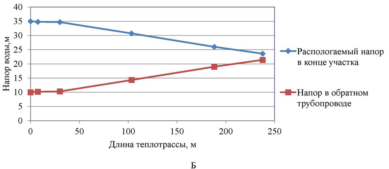
Рисунок 2.8 – Пьезометрический график тепловой сети БМК п. Березовка
