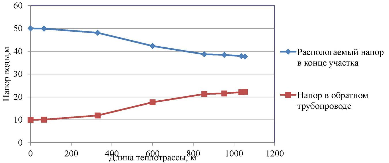
Рисунок 2.7 – Пьезометрический график тепловой сети Котельной п. Каменский
