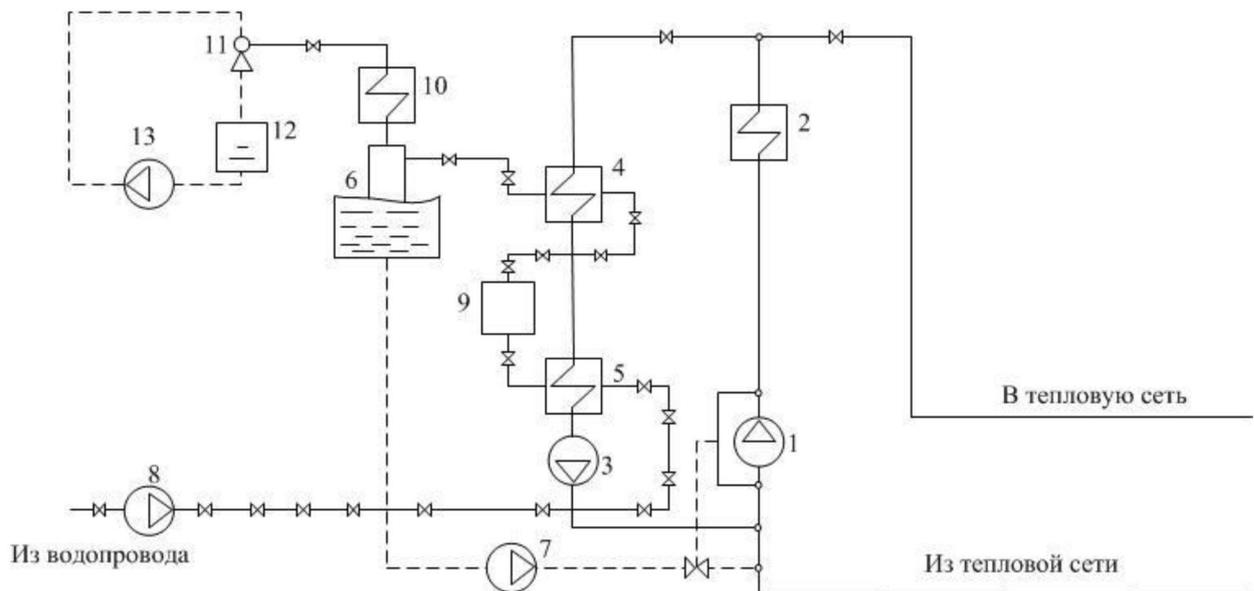
Рисунок 2.4 – Принципиальная тепловая схема котельной с водогрейными котлами:
