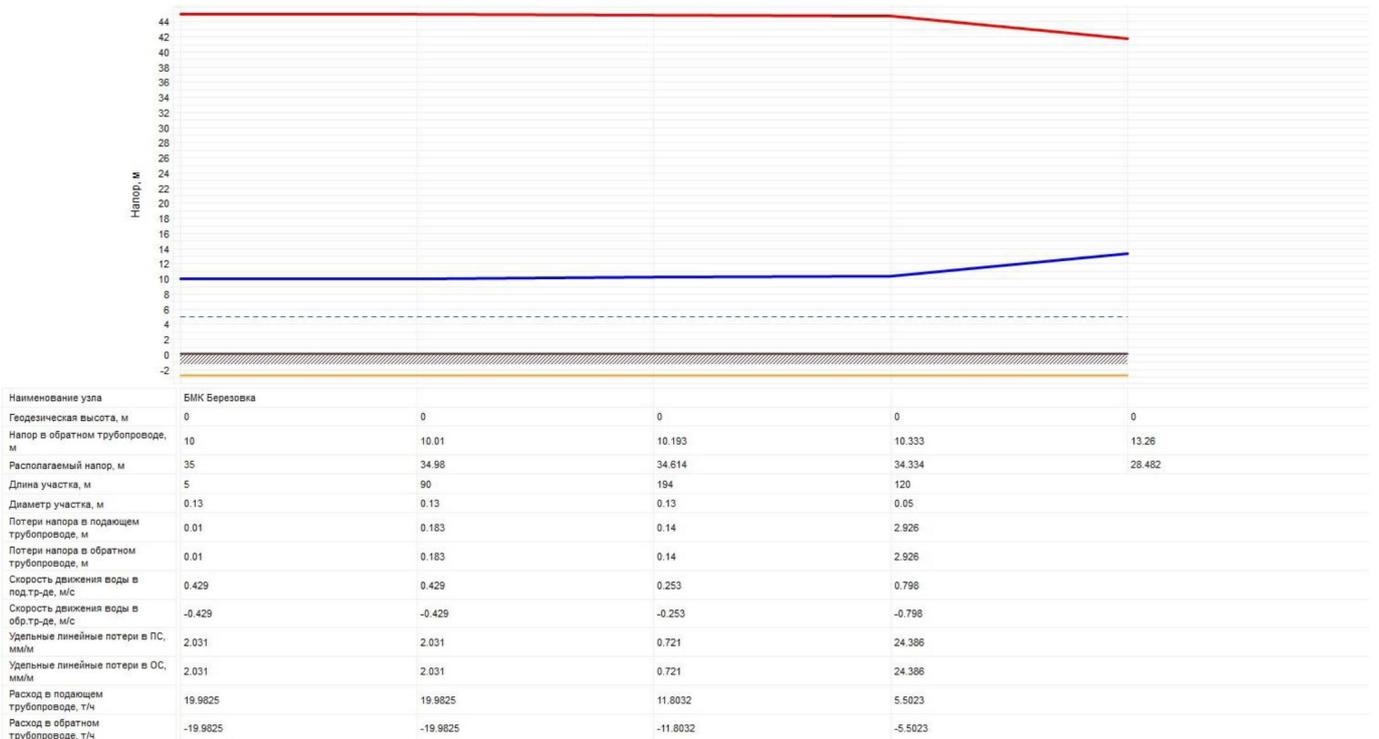
Рисунок 2.17 – Пьезометрический график от источника теплоснабжения (БМК п. Березовка) до самого удаленного потребителя
