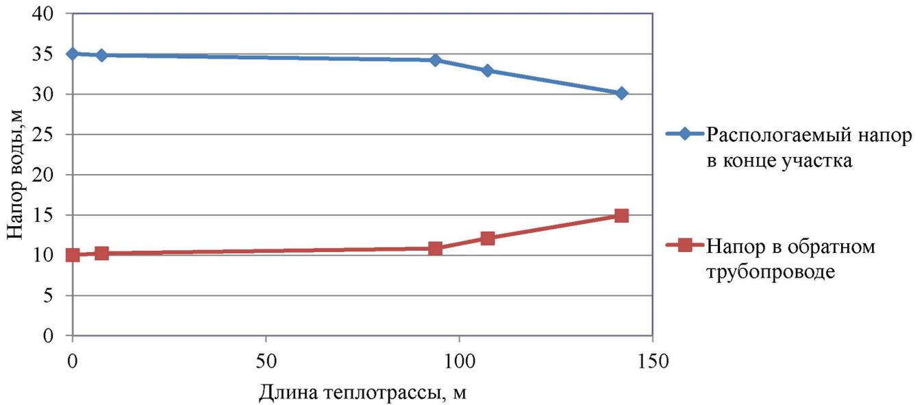
Рисунок 2.11 – Пьезометрический график тепловой сети БМК п. Березовка до здания школы
