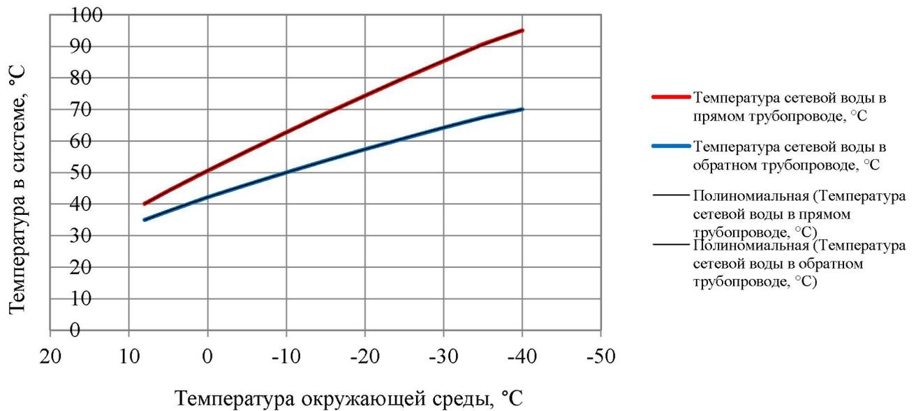
Рисунок 2.5 – График изменения температур теплоносителя 95–70 °С
