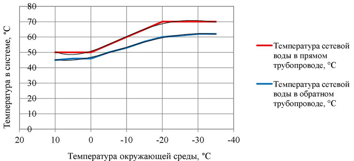
Рисунок 2.6 – График изменения температур теплоносителя 85–64 °С
