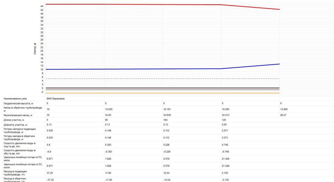
Рисунок 2.20 – Пьезометрический график от источника теплоснабжения (БМК п. Березовка) до административного здания в аварийной ситуации
